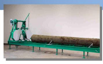
Мощность главного электродвигателя 15 kW (с устройством плавного пуска)
